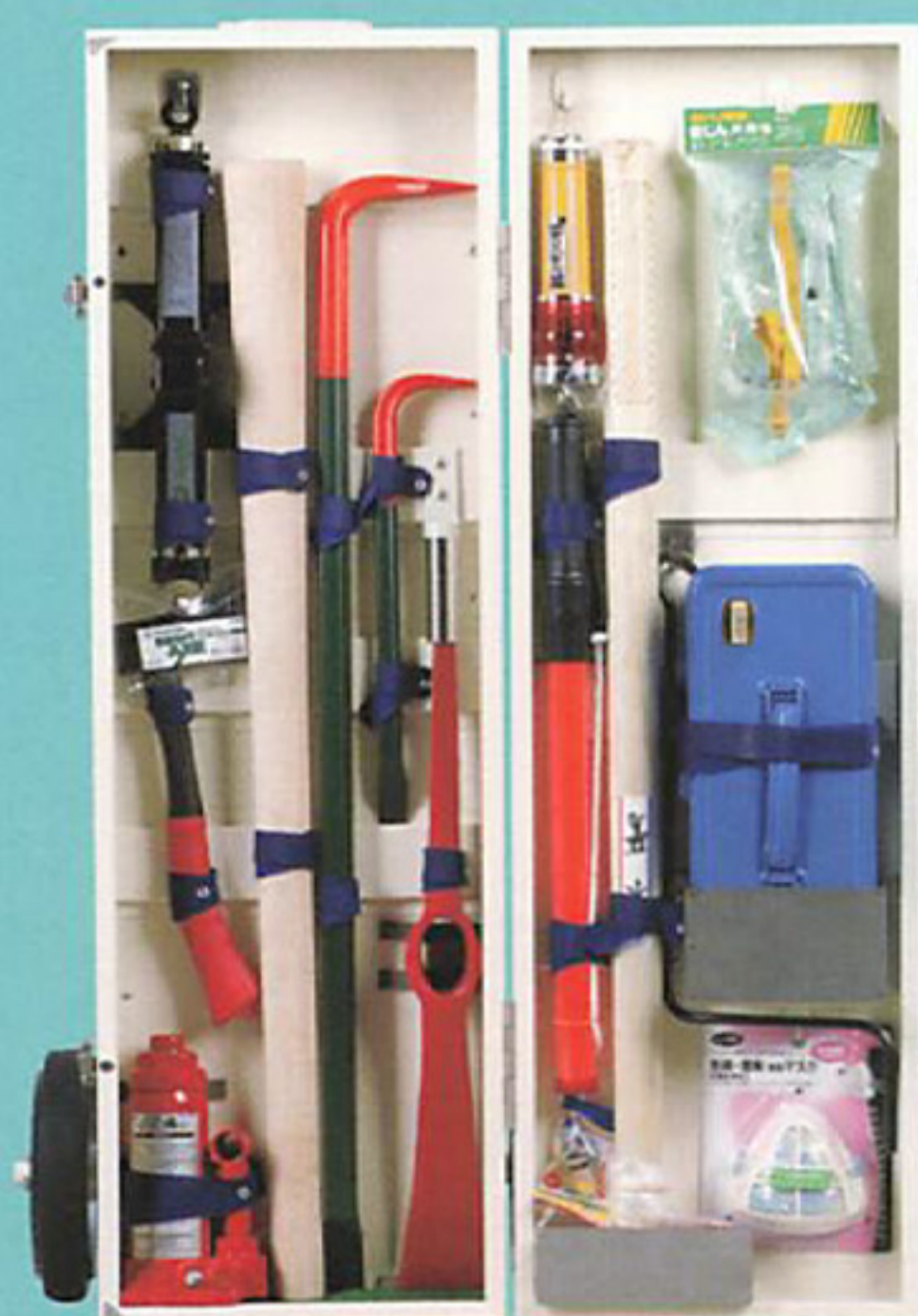
格納箱本体（総重量約42kg） 150×300×1,000×1.2mm
